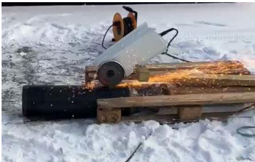
Figur 15. Försök med att punktera en trycklös flaska. Punktering tog ca 10 sekunder.
