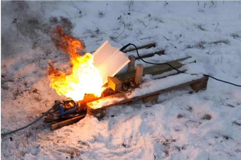
Figur 17. Bild direkt efter att håltagning skett och gasen antänds.
