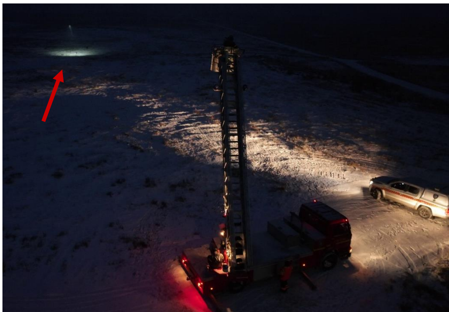
Figur 9. Belysning med extern lampa ME2 Spotlight. Se belysningspunkt via röd pil.
