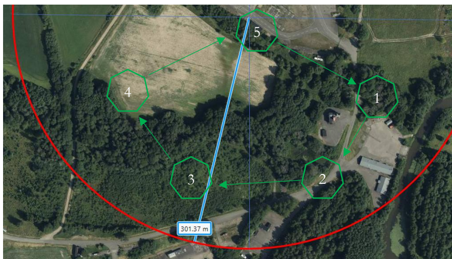
Figur 13. Exempel på flygmönster med fasta punkter. Detta rekommenderas då fokus på flygning och bildanalys separeras.
