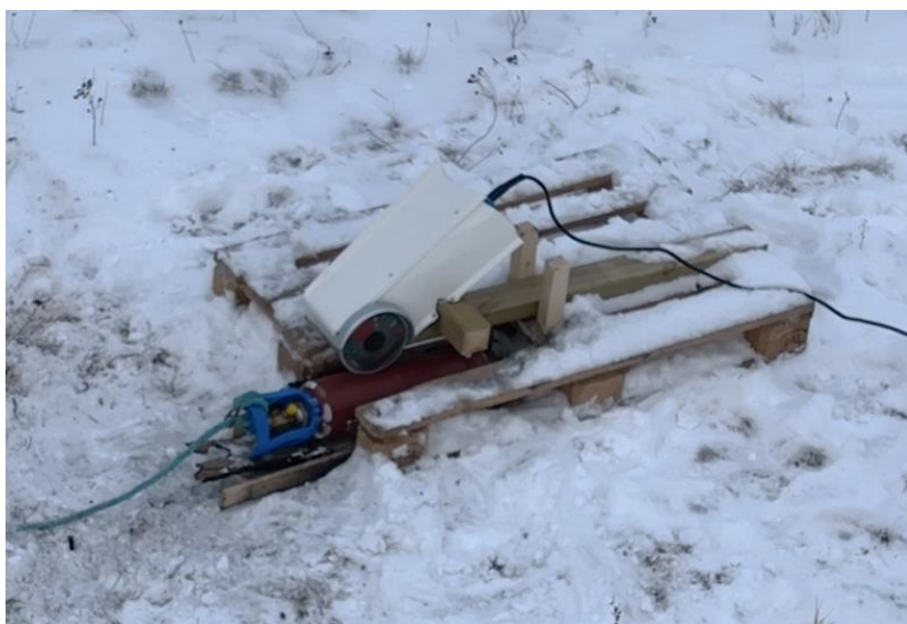
Figur 16. Försöksuppställning med att punktera en trycksatt acetylen­gas­flaska. Punktering tog ca 7 sekunder.
